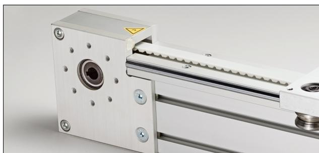
A linha de eixos elétricos Cargo 200 é movida por correia dentada e a carga é guiada por um sistema de quatro rodízios sobre duas barras cilíndricas de 10mm, possibilitando movimentos lineares rápidos e consistentes. A linha Cargo 200 pode ser combinada com outras linhas de atuadores formando sistemas de manipulação com vários eixos de movimentação.
