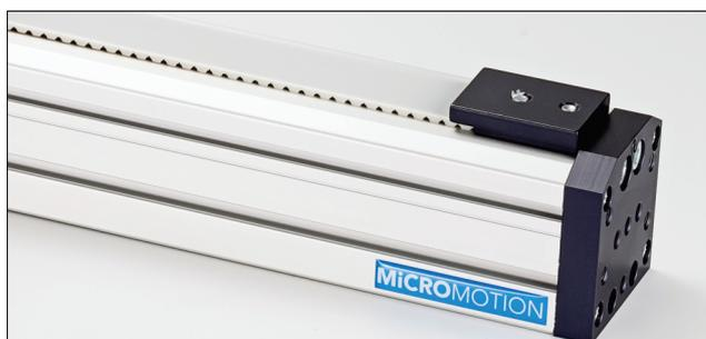
A linha de eixos elétricos Lift 80 é movida por correia dentada e a carga é guiada por um sistema de patins duplos sobre uma guia linear de tamanho 20mm, possibilitando movimentos lineares suaves.
