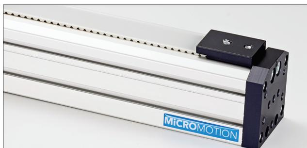
A linha de eixos elétricos Lift 55 é movida por correia dentada e a carga é guiada por um sistema de patins duplos sobre uma guia linear de tamanho 15mm, possibilitando movimentos lineares suaves.
