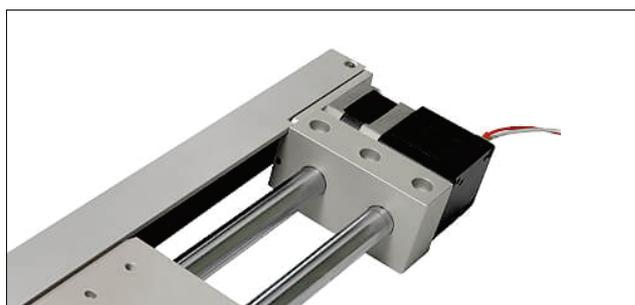
Os eixos elétricos da linha Tug 25 são atuadores deslizantes com um sistema de quatro rolamentos de esfera sob barras cilíndricas para pequenas cargas, garantindo um movimento estável.
