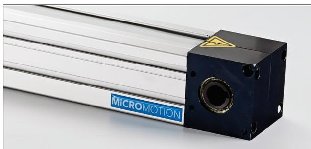
A linha de eixos elétricos Solid 55 é movida por correia dentada e a carga é guiada por um sistema de patins duplo sobre uma guia linear de tamanho 15mm, possibilitando movimentos lineares suaves. A linha Solid pode ser combinada com outras linhas de atuadores formando sistemas de manipulação com vários eixos de movimentação.
